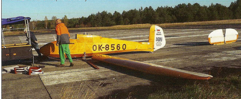
Montáž větrně na prahu dráhy
